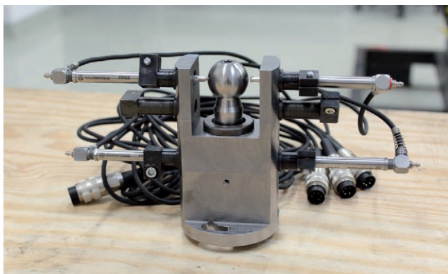
Detail na meraciu vidlicu s vloženým guľovým čapom
